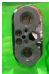
Presca di ricarica trifase DIN 320 opzionale sulla macchina, A464123
