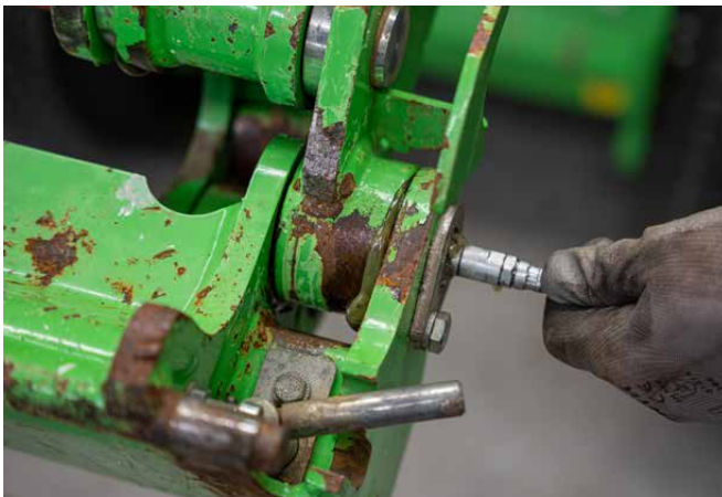
Kuvassa rasvataan kuormaajan työlaitekiinnikkeen tappeja.
